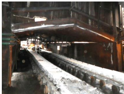
Рис. 3. Конвейер с мутьдами в наклонной галерее РМ-1
