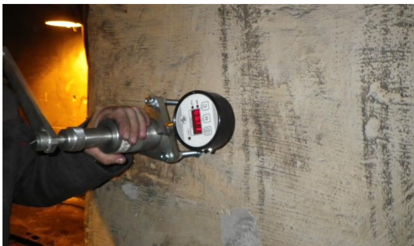
Рис. 5. Определение значения прочности бетона прибором «ПИБ»
