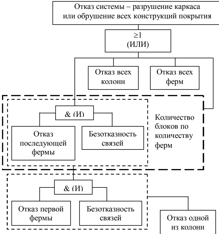
Рис. 1. Дерево неисправностей системы «каркас здания»
