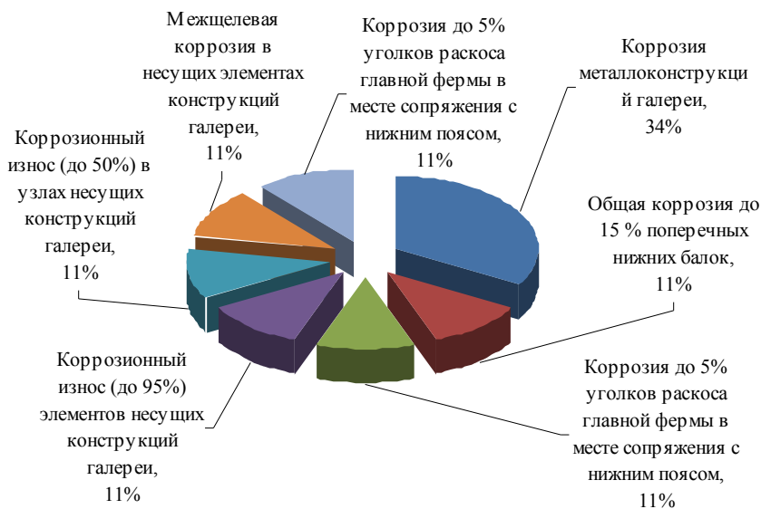
Рис. 8. Коррозия элементов ферм
