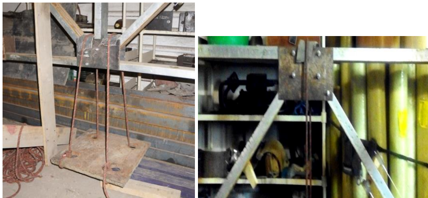
Рис. 2. Приложение нагрузки в узлы верхнего и нижнего поясов
