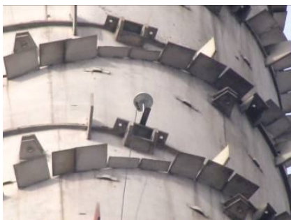
Рис. 4. Роверная станция GPS Trimble-5700, частота регистрации 5 Гц
