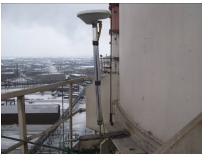
Рис. 7. Антенна Zephyr на высоте 50 м
