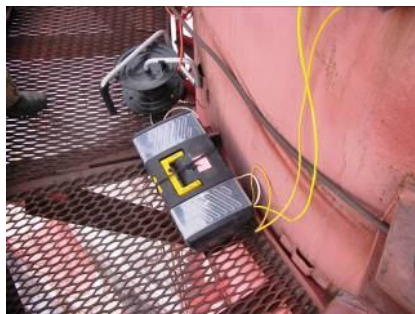
Рис. 3. Антенна Zephyr-Geodetic на высоте 96 м
