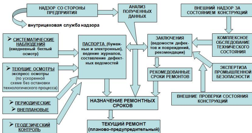
Рис. 1. Схема непрерывного мониторинга технического состояния строительных конструкций
