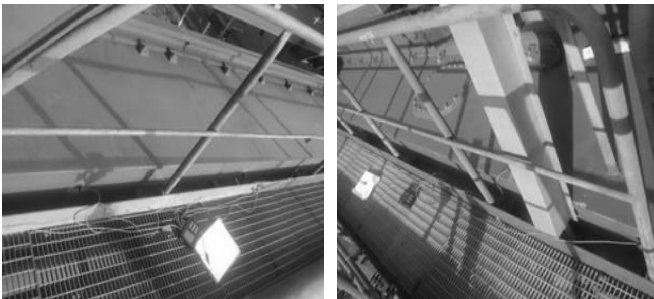
Рис. 2.26. Схема расположения вибродатчиков
