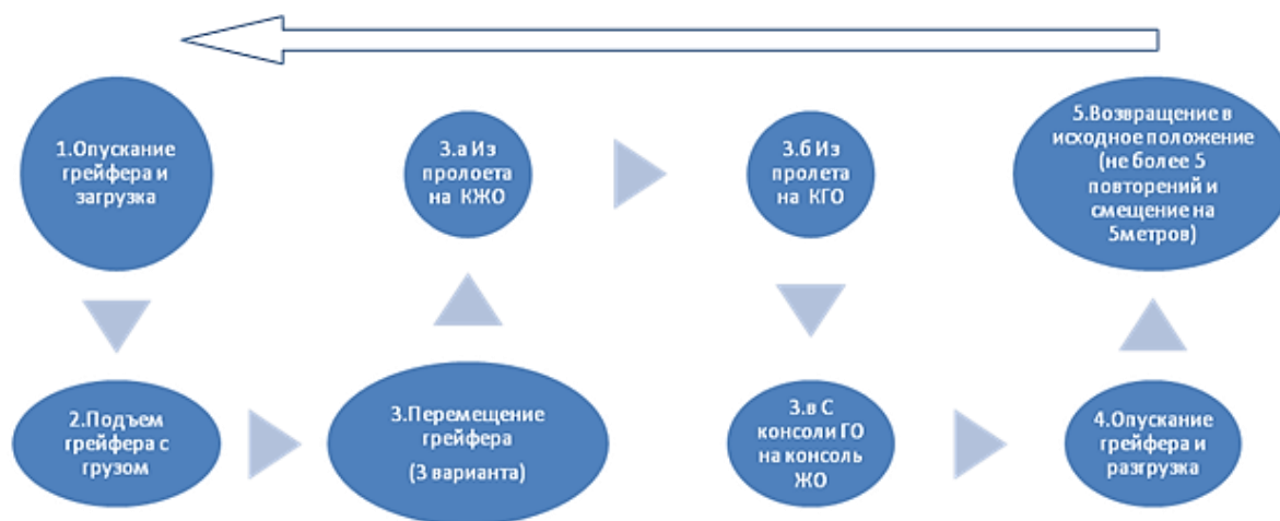
Рис. 3.15. Принципиальная логистическая блок-схема работы грейферной тележки
