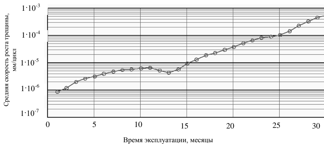
Рис. 3.24. Диаграммы роста усталостной трещины (периоды годовых колебаний скорости роста трещины)
