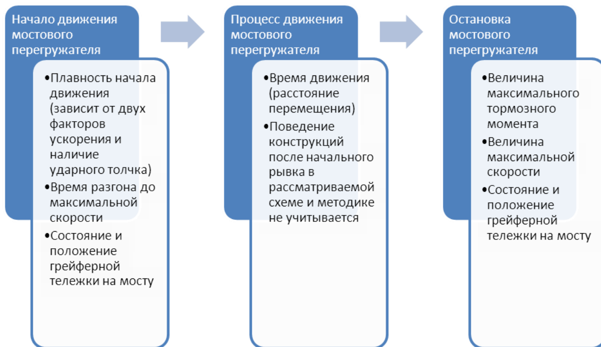
Рис. 3.12. Принципиальная логистическая блок-схема передвижения мостового перегружателя
