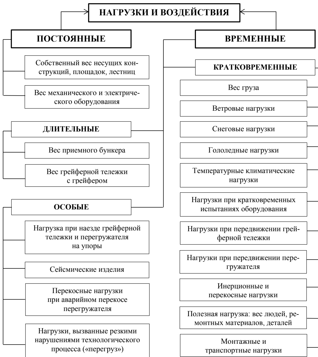
Рис. 1.18. Схема нагрузок и воздействий на мостовые перегружатели
