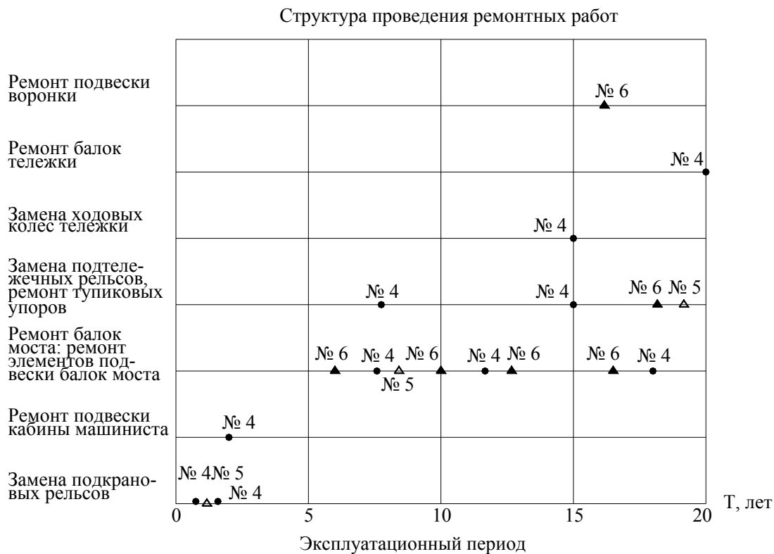
Рис. 1.46. Периодичность проведения ремонтных работ на мостовых перегружателях с ездовыми балками коробчатого сечения КХП ОАО «ММК»
