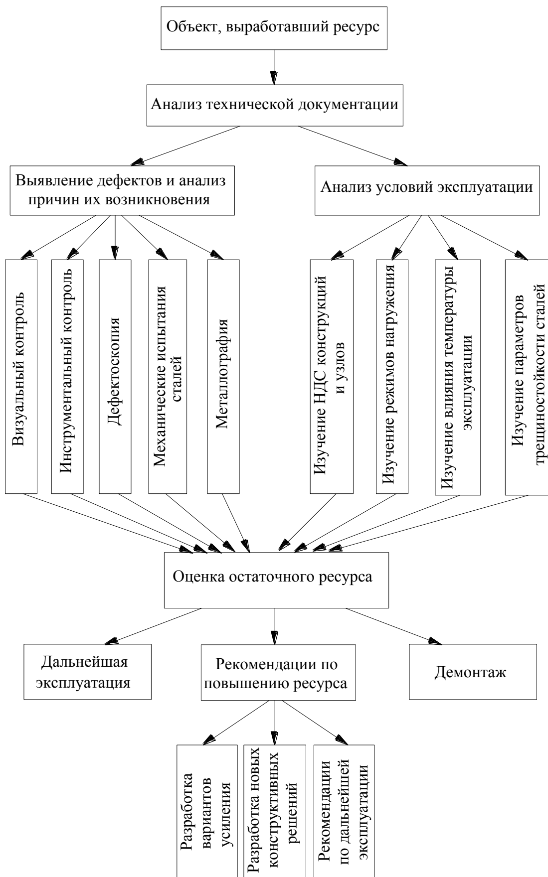
Рис. 3.1. Схема методики оценки ресурса ездových балок мостовых перегружателей металлургических производств
