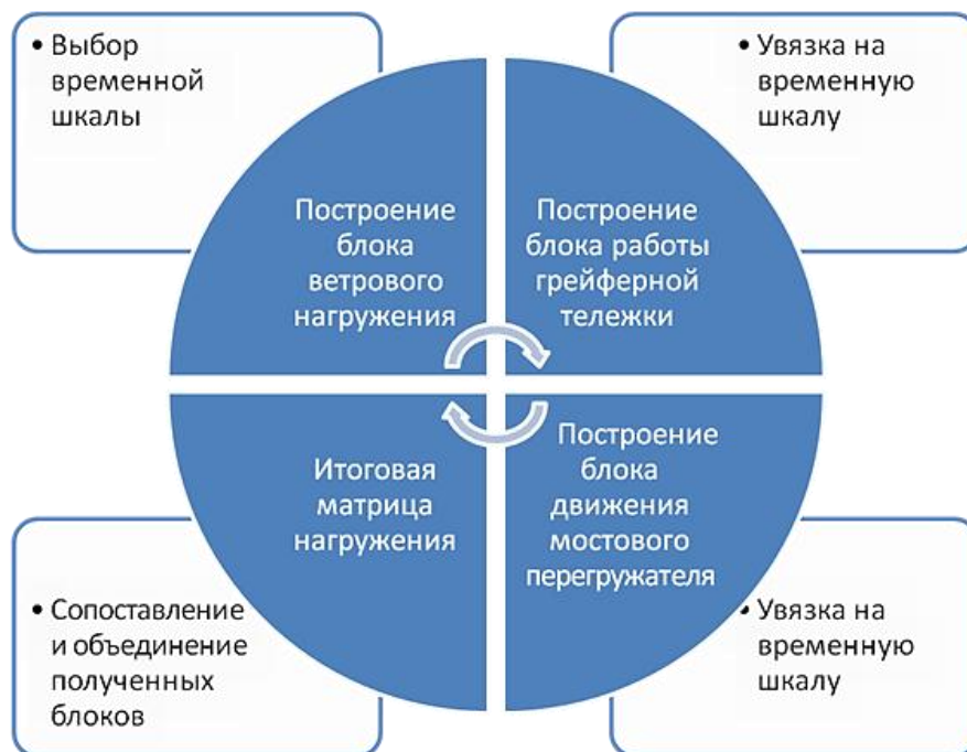
Рис. 3.8. Принципиальная схема построения блоков нагружения
