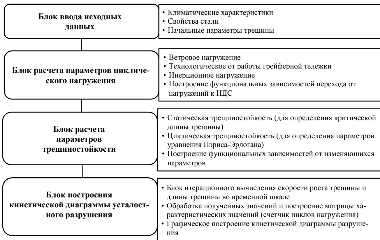
Рис. 3.22. Блок-схема итерационного процесса расчета остаточного ресурса
