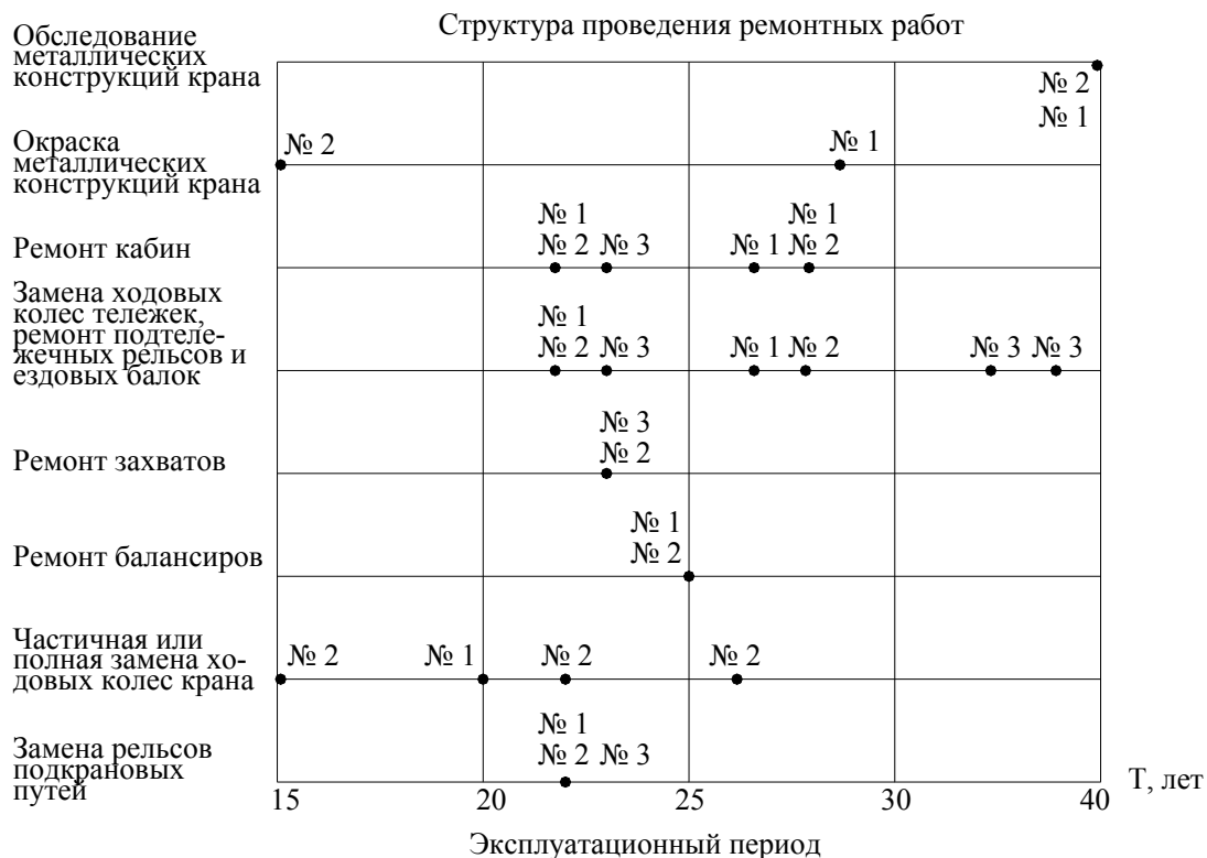
Рис.1.45. Периодичность проведения ремонтных работ на мостовых перегружателях с ездовыми балками двутаврового сечения КХП ОАО «ММК»
