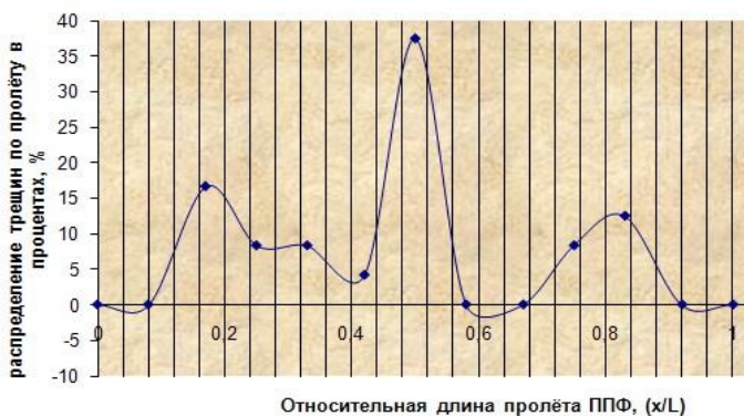
Рис. 1. График распределения активно растущих трещин по пролёту ППФ
