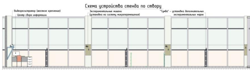
Рис.3.1. Общее компоновочное решение стенда «Створ»
