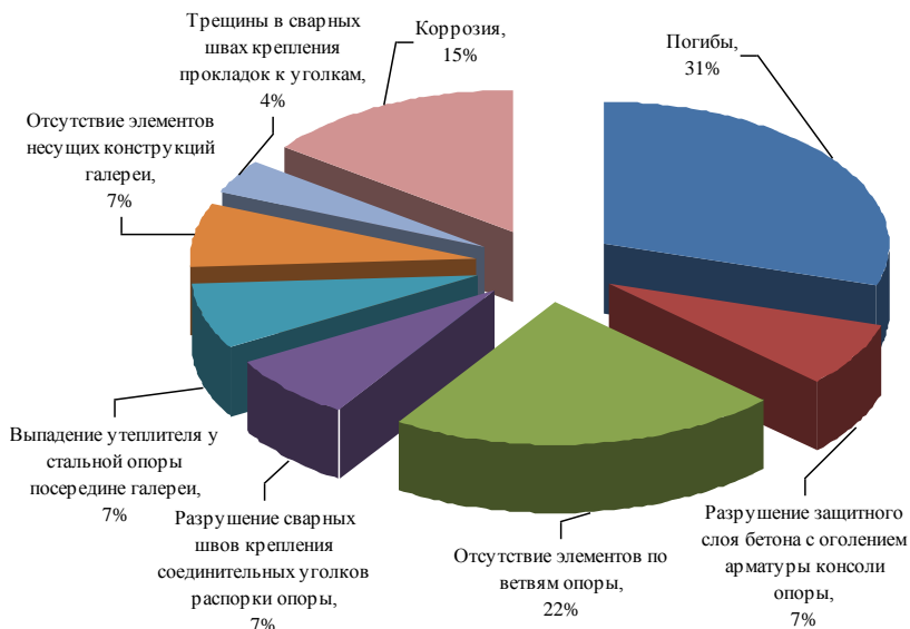
Рис. 9. Повреждаемость опор и их элементов
