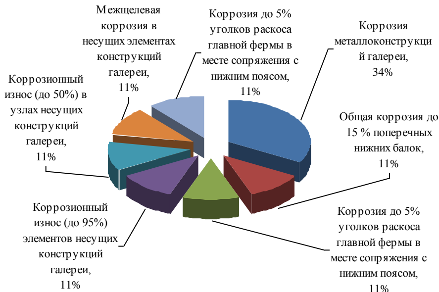
Рис. 8. Коррозия элементов ферм
