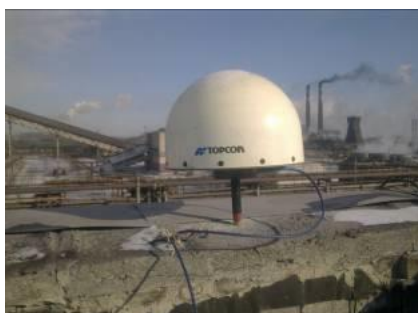
Рис. 8. Базисная станция «GB-500» GNSS GB-500, частота регистрации 1 Гц
