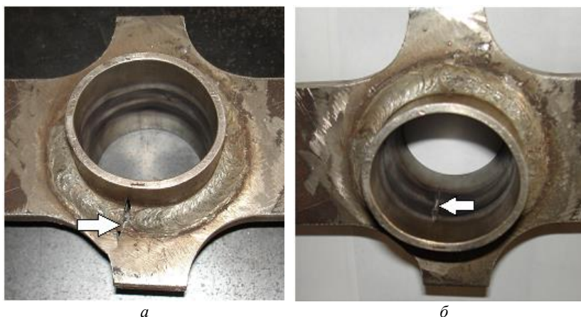
Рис. 3. Характер усталостного разрушения образцов: а – трещина в сварном шве; б – трещина на внутренней стороне патрубка
