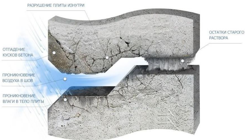
Рис. 3. Последствия незаполненного шва
