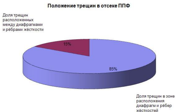
Рис. 3. Круговая диаграмма положения трещин по отношению к диафрагмам и ребрам жёсткости в ППФ
