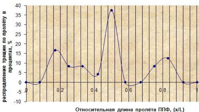
Рис. 1. График распределения активно растущих трещин по пролёту ППФ
